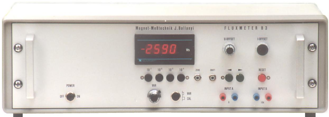
Das Fluxmeter B3 ist ein elektronisch integrierendes, digital anzeigendes Instrument mit hoher Empfindlichkeit und äußerst geringer Drift. Seine Vielseitigkeit ermöglicht den Einsatz im Laborbetrieb wie auch in der Produktion.
